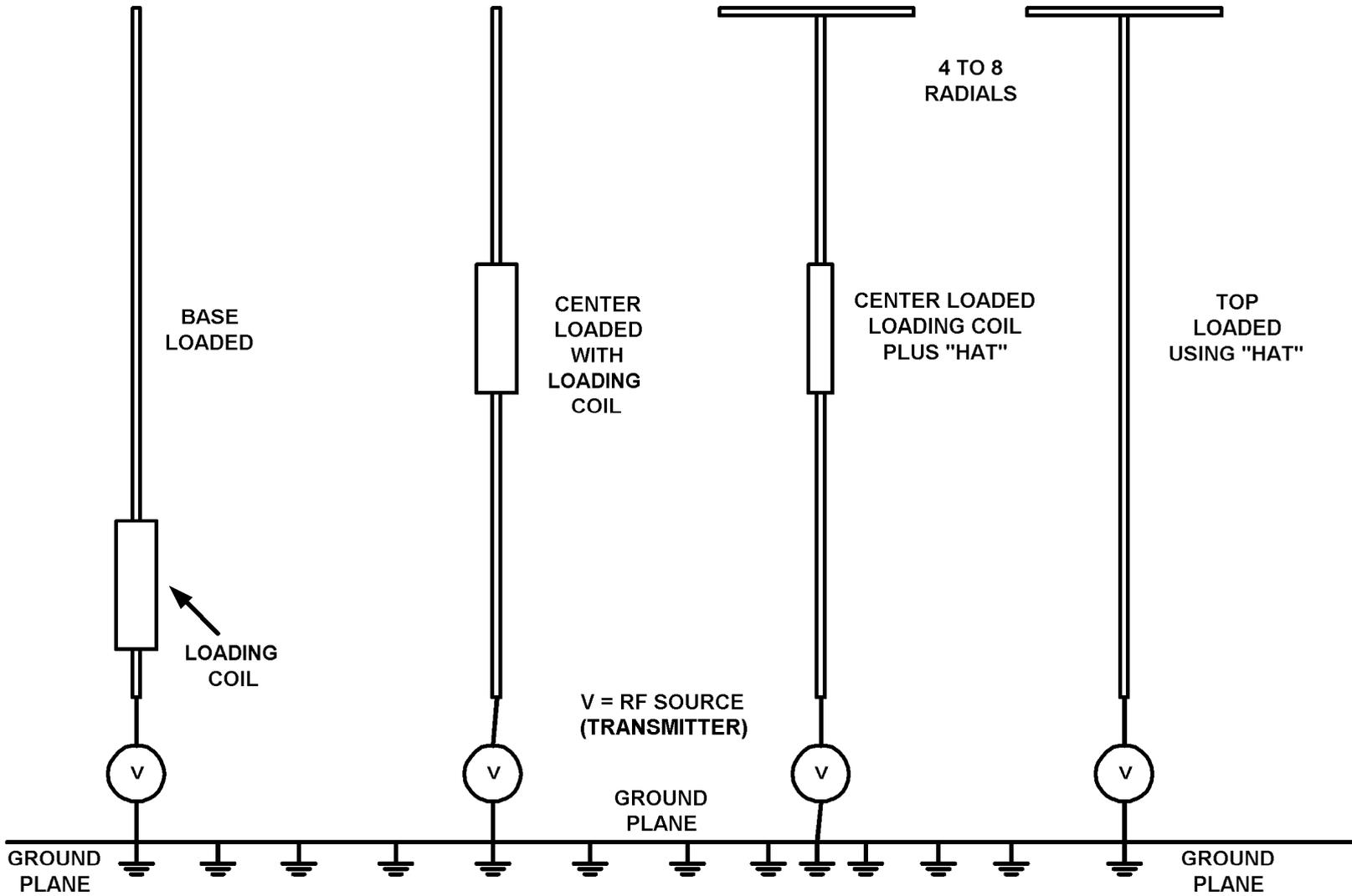
TYPES OF VERTICAL ANTENNAS SUITABLE FOR LOW POWER TRANSMITTERS
