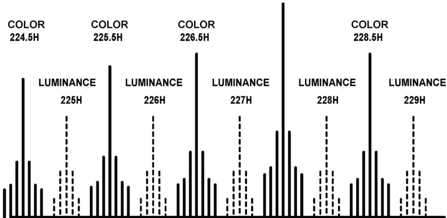
FIG 2 SPECTRUM OF TV SIGNAL AROUND 3.58 MHz SHOWING
